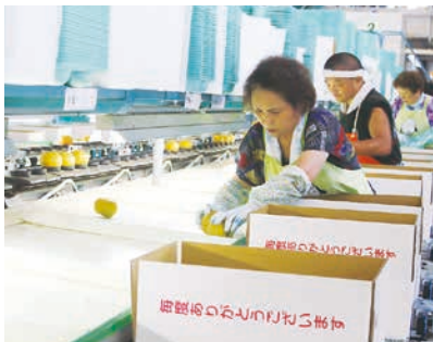
③光センサーにより選果された梨は等級ごとに分けられ、箱詰めされます。
