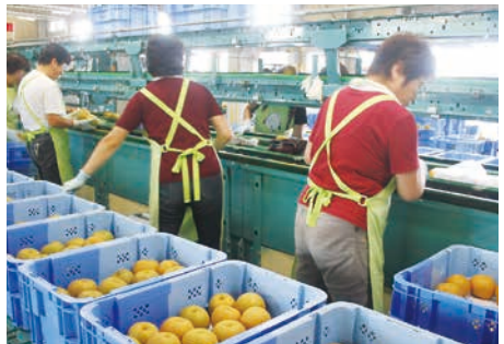
②梨の表面に傷などがないか目視で確認し、ベルトコンベアに乗せます。
