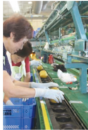
②梨の表面に傷などがないか目視で確認し、ベルトコンベアに乗せます。
